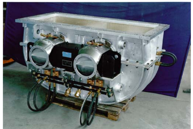
Bild 7. Rinneninduktor: Nennleistung 500 KW; Nennspannung 550/620 V; Nennfrequenz 50/60 Hz
