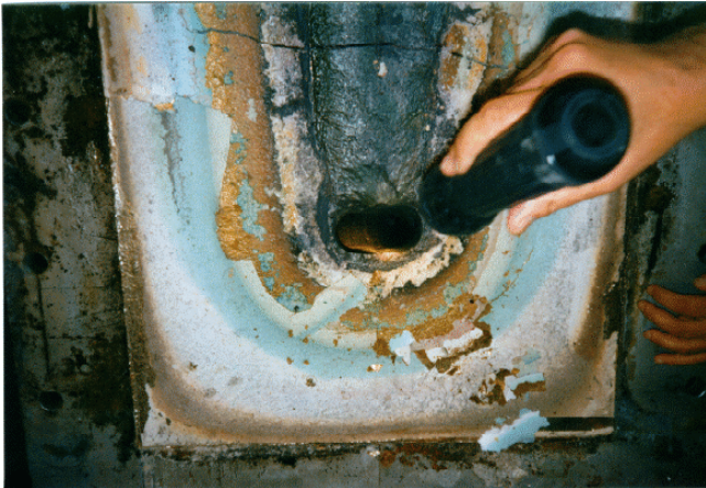
Bild 8. Rinnenzustand nach 14 Monaten Betriebszeit (Seitenkanal)
